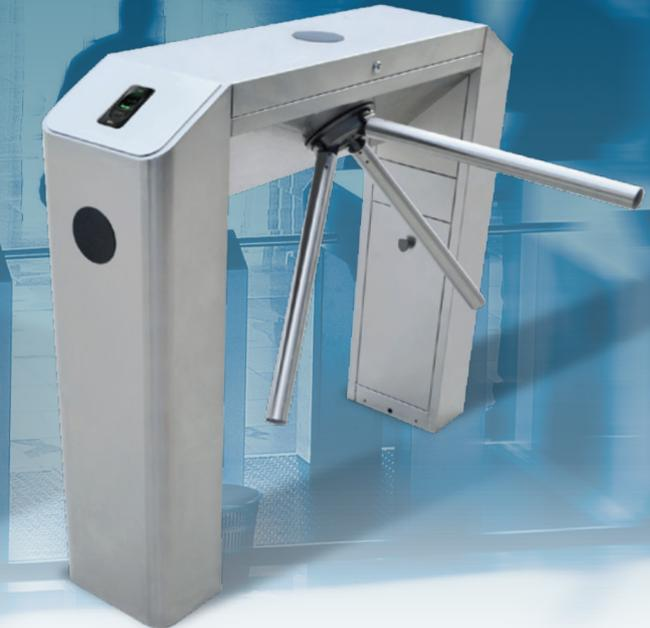
Construido en acero inoxidable SUS304, el **Molinete TS-2000 Pro** incorpora la más alta tecnología dentro de un diseño compacto y elegante, ofreciendo un funcionamiento estable y silencioso. Su construcción electromecánica está especialmente diseñada para disminuir el desgaste y el consumo de energía ya que sus electroimanes de bloqueo sólo operan cuando el acceso es denegado. Ideal para áreas con alto flujo de personas. Sus brazos son colapsables en caso de emergencia.
